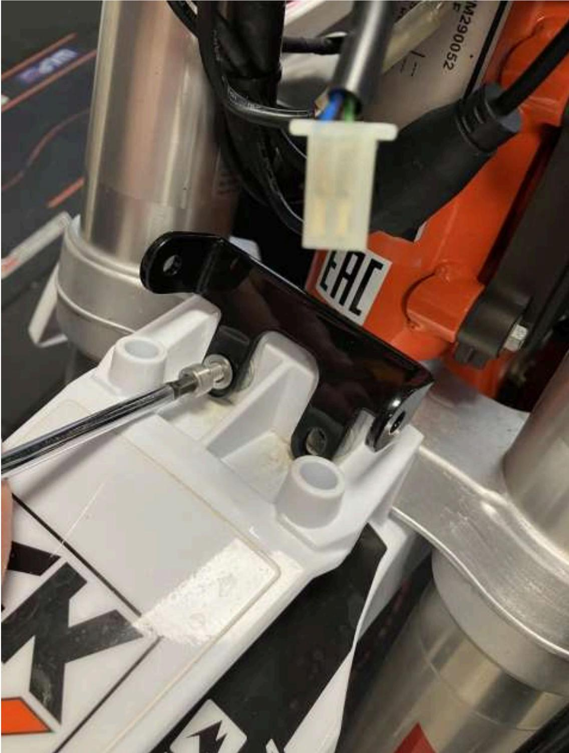
Prémontez le support supérieur en utilisant les points de fixation d'origine du compteur de la moto.
