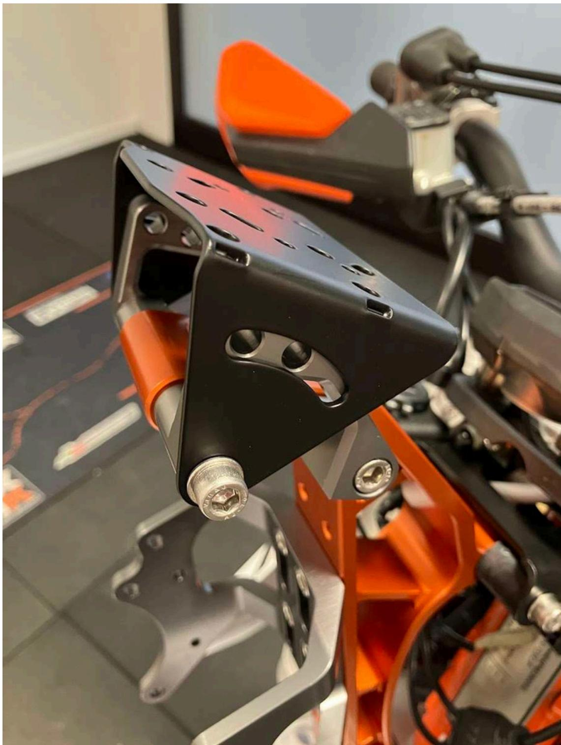
Servez-vous de la seconde vis pour ajuster l'angle d'inclinaison de la platine.
