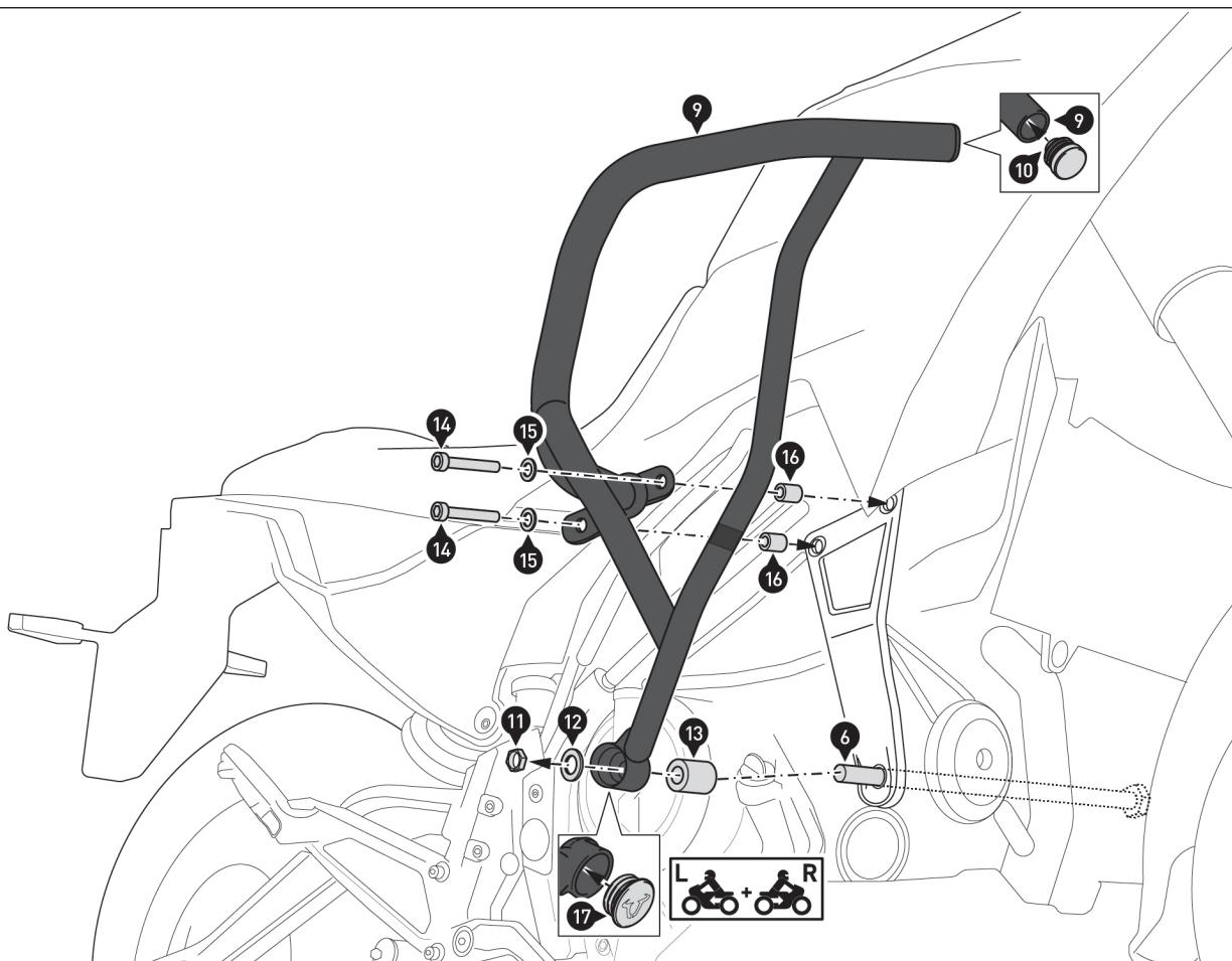
Insérez le bouchon plastique (10) dans l'extrémité du crashbar (9).
