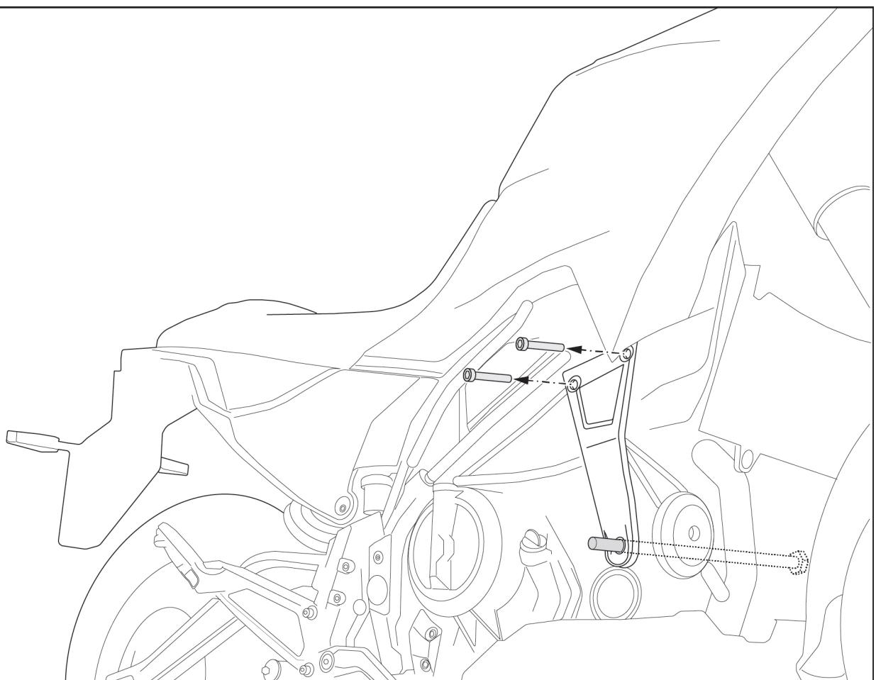
Retirez les vis indiquées sur le côté **droit** du véhicule.
