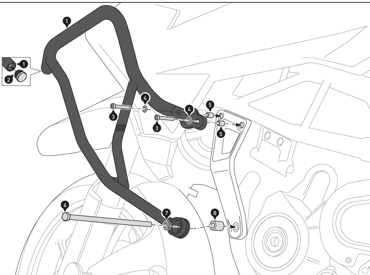
Insérez le bouchon plastique (2) dans l'extrémité du crashbar (1).
